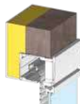
Volet roulant intégré enroulement extérieur
