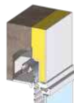
Volet roulant 1/2 linteau incorporé à la menuiserie
