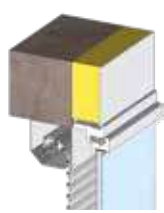
Volet roulant enroulement extérieur
