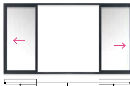
4 vantaux - 2 rails Largeur jusqu'à 6,20 m
