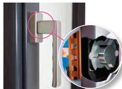
Poignée avec système Secustik® rend impossible l'ouverture du mécanisme par l'extérieur.
