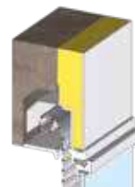
Volet roulant 1/2 linteau incorporé à la menuiserie
